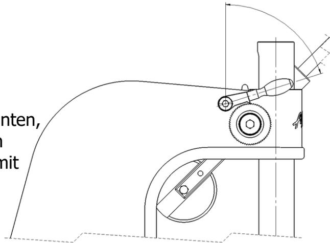
Mit dem Ratschenhebel wird die Druckbewegung ausgeführt. Durch Umlegen des Hebels der Arretierung am Handrad wird die Zahnstange mittels Sperrfunktion einer Rastscheibe (Sperrrad) gegen die Aufwärtsbewegung verriegelt (eine Expansion von 1mm ist zulässig).
