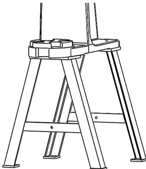
Die Dornpresse mit Untergestell ist unter allen Umständen mit geeigneten Befestigungsmitteln am Boden gegen unkontrolliertes Verrutschen oder Kippen zu sichern (siehe Aufstellung der Presse).
